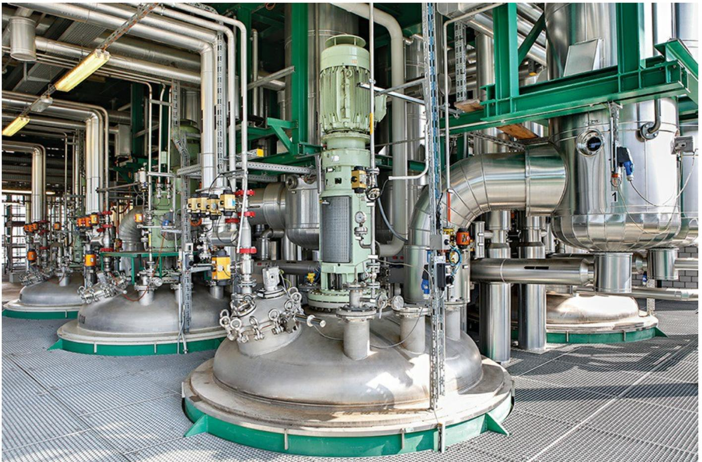
甚至对于因使用重型搅拌机而致表面运动剧烈的介质，80 GHz 的雷达传感器也能可靠地测量物位。
