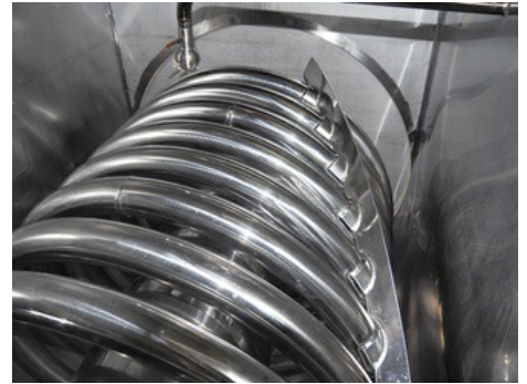
用一个自转的加热线圈在槽式炉中加热蔬菜，而 VEGAPULS 64 则在其中连续监视物位。
